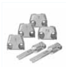
Punzone 2 / 3 Per lamiere profilate < 3,2 mm Matrice P5 Per lamiere profilate 3–5 mm Matrice 2 Per spessore lamiera < 2 mm acciaio e acciaio inox Matrice 3 Per spessore lamiera < 3,2 mm acciaio Matrice 5 Per spessore lamiera < 5 mm acciaio
